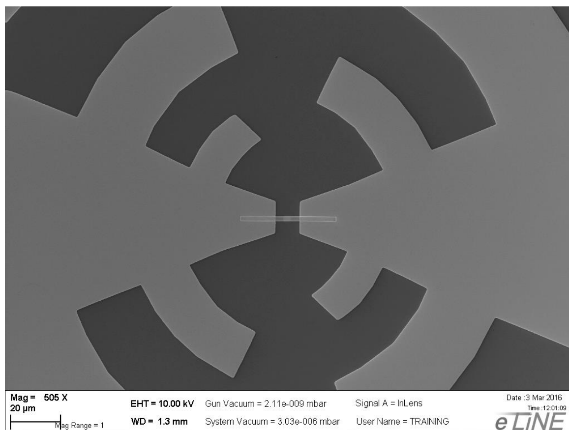
Рисунок 2.15. Изображение в электронном микроскопе используемой логопериодической антенны с интегрированным болометром.
