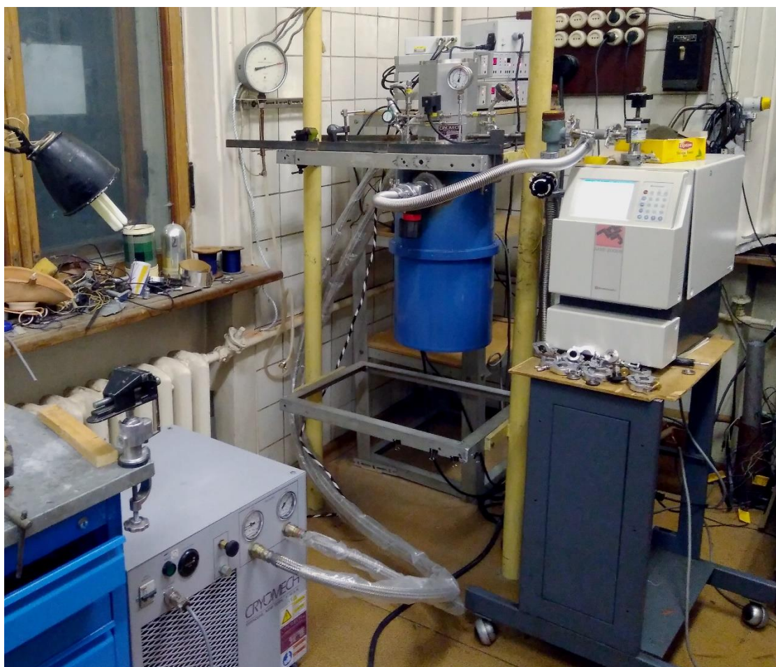
Рисунок 3.4. Внешний вид криостата фирмы Oxford – Heliox AC-V.
