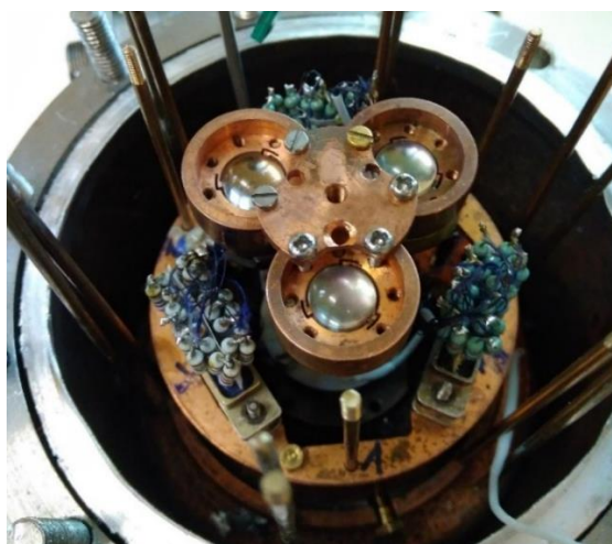
Рисунок 4.2. Внешний вид внутренней части криостата с тремя установленными образцами в держателях с линзами.
