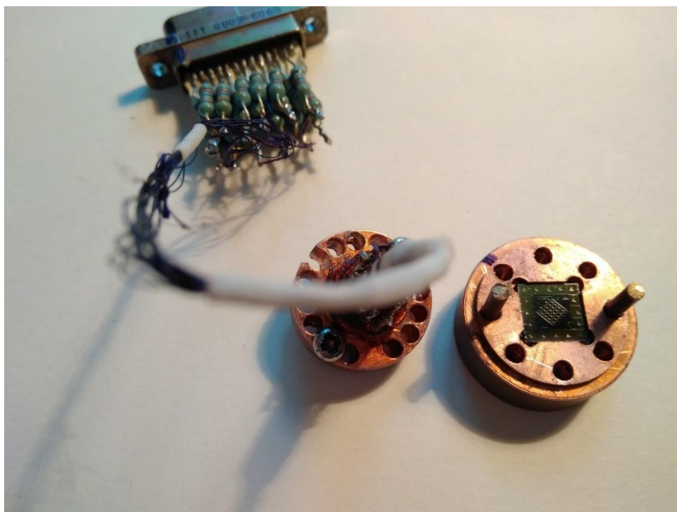
Рисунок 3.5. Общий вид держатель для измерений в криостате с 25 контактными разъёмом с распаянными на нем защитными резисторами.
