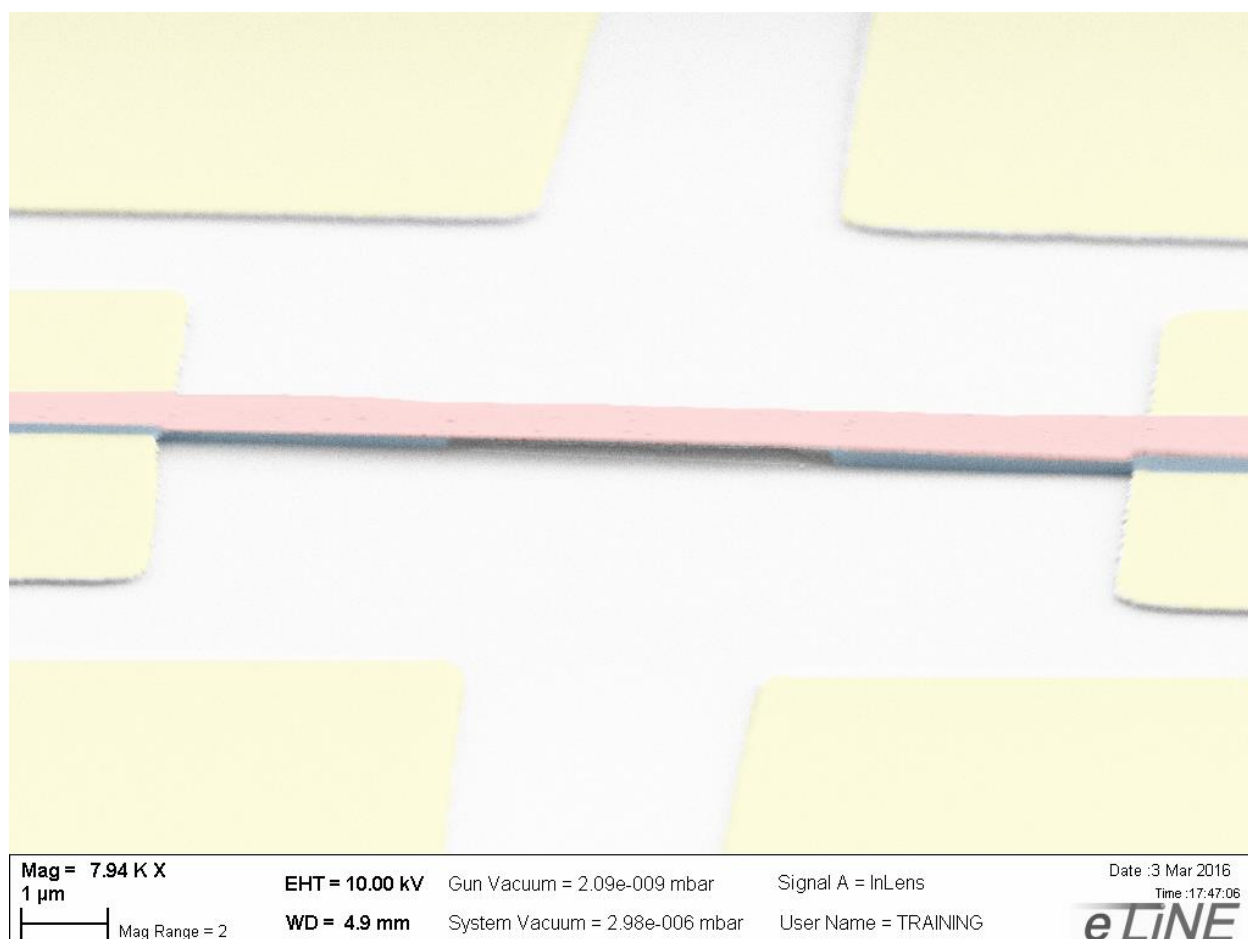
Рисунок 2.14. СЭМ-изображение изготовленного образца, черно - белая картинка с электронного микроскопа была дополнительно раскрашена в соответствие со схематичным изображением на рисунке 2.11
