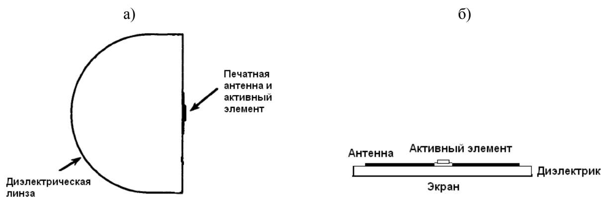
Рисунок 1.4. а) АГ с выводом излучения через диэлектрическую линзу; б) АГ с металлизацией тыльной стороны диэлектрической подложки.
