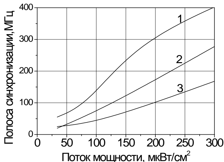
Рисунок 4.6. Зависимость полосы синхронизации для отдельно взятой АГ (1) и линейных решеток из двух (2) и трех (3) взаимно синхронизированных АГ от потока мощности синхросигнала.
