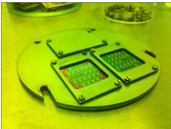
Рисунок 2.13. Фотография столика – держателя образцов с двумя кремниевыми пластинами перед процедурой магнетронного распыления верхнего подводящего Nb – электрода.
