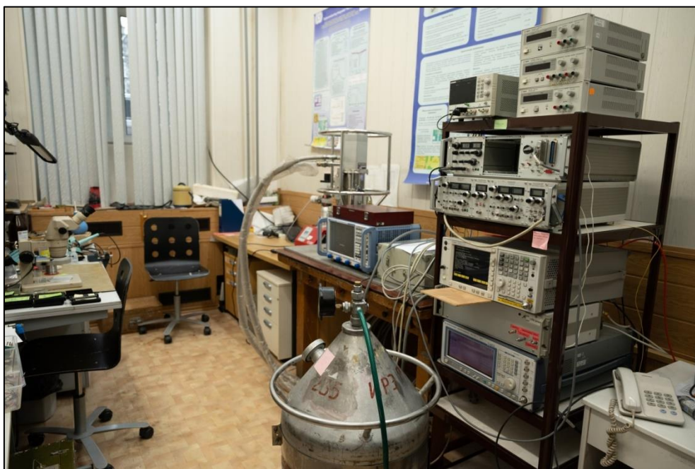
Рисунок 2.15. Фотография экспериментально стенда для измерения по постоянному току. Криозонд с измеряемым образцом погружается на дно гелиевого сосуда Дьюара; к внешней стороне зонда подходят электрические кабели, соединенные с блоками смещения.
