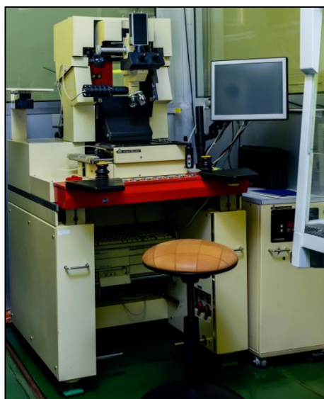
Рисунок 2.6. Фотография установки совмещения и экспонирования Karl Suss MA150 (слева). Рисунок, поясняющий последовательность основных технологических слоев для изготовления рабочих структур на примере чипа с одним слоем изоляции (справа).
