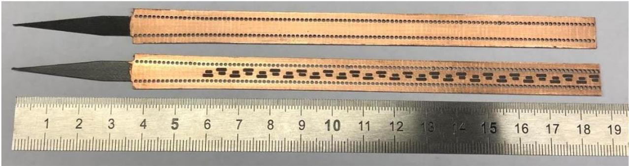
Рис. 1.16. Экспериментальный образец антенны.
