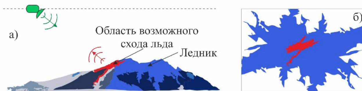
Рисунок 6.7. а) – Предполагаемая схема радиозондирования с использованием РСА в диапазонах, близких длинам автоволн пластического течения; б) – ожидаемая более «яркая» область ледника на радиоизображении, где возникают периодические структуры, рассеивающие излучение радара
