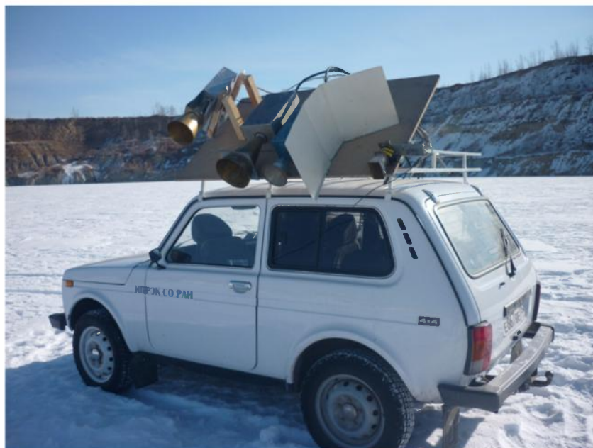
Рисунок 2.17. Фотография радиофизического комплекса, установленного на автомобиль «Нива»
