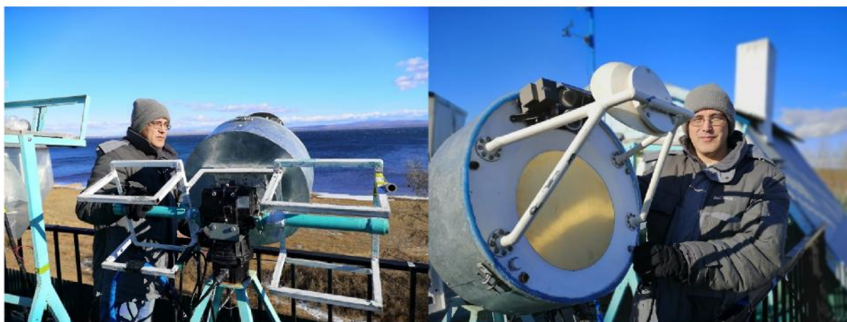
Рисунок 2.15. Фотографии установки для наблюдений отражённого от «серебристых» облаков микроволнового излучения Солнца после его захода. Три радиометра на одной антенне (от 20 ГГц до 94 ГГц)
