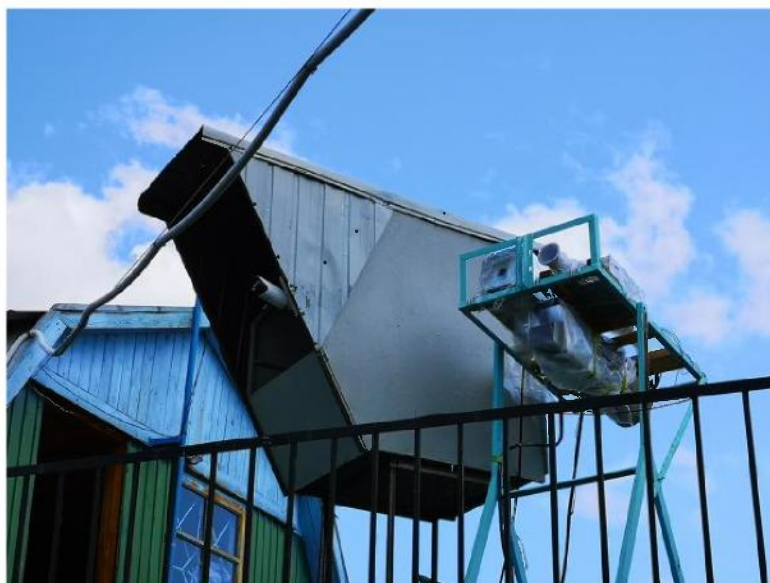
Рисунок 2.16. Фотография установки для наблюдений отражённого от «серебристых» облаков микроволнового излучения Солнца после его захода (общий вид всех радиометров). Стационар ИПРЭК СО РАН (с. Преображенка, Забайкальский край)
