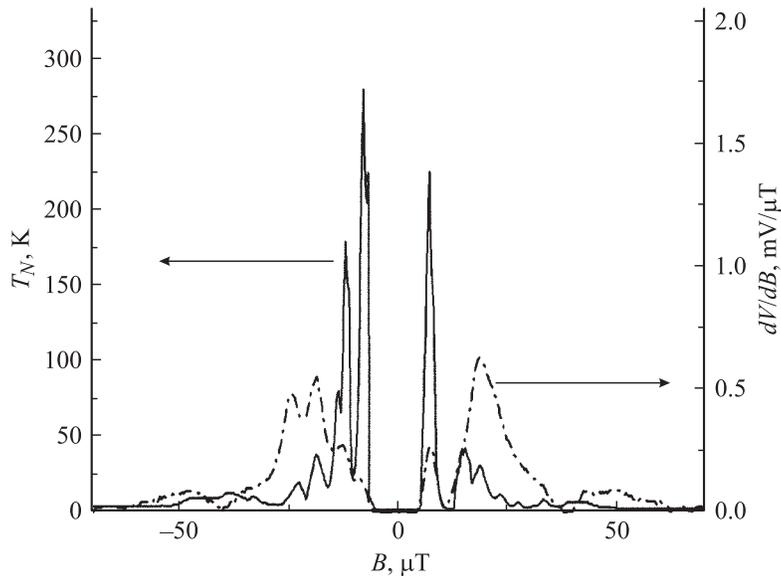
**Рис. 3.** Зависимости от магнитного поля  $B$  эквивалентной мощности температуры шума  $T_N$  на выходе СКИФа (сплошная линия), измеренная в полосе частот 1–2 GHz, и крутизна сигнальной характеристики СКИФа  $\partial V/\partial B$  (пунктирная линия).
