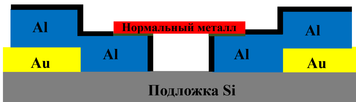
Рис. 2. Схематическое изображение конструкции болометра, окончательная версия. Серый – кремниевая подложка, желтый – золотая разводка и антенны, синий – сверхпроводящий алюминий, красный – нормальный абсорбер (медь, палладий, или гафний), зеленый – область туннельного барьера, черный – окисел на поверхности алюминия.
