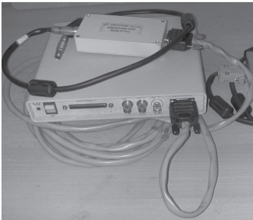
Рис. 4. Фотография СКВИД-электроники и блока управления макета одноканального СКВИД-градиентометра.
