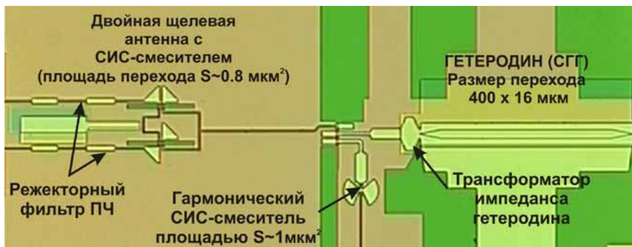
Рис. 1. Фотография центральной части микросхемы интегрального приемника (показана область 1,2 \times 0,5 \text{ мм}^2 ).
