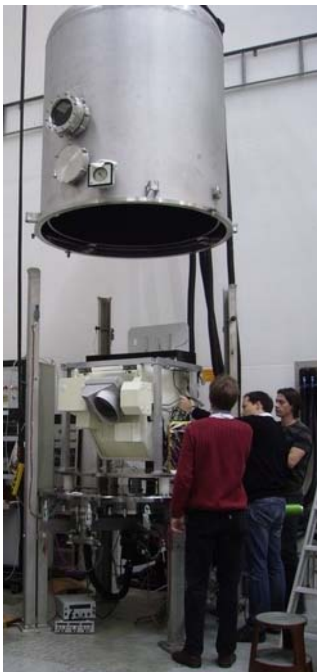
Рис. 4.7. Установка для проведения термовакuumного теста.
