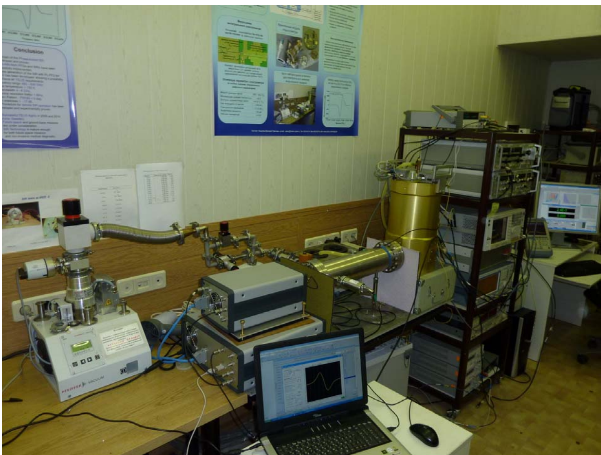
Рис. 5.7. Фотография лабораторной установки для исследования спектров поглощения газов.
