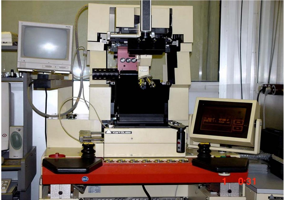
Рис. 2.6. Установка совмещения и экспонирования МА150
