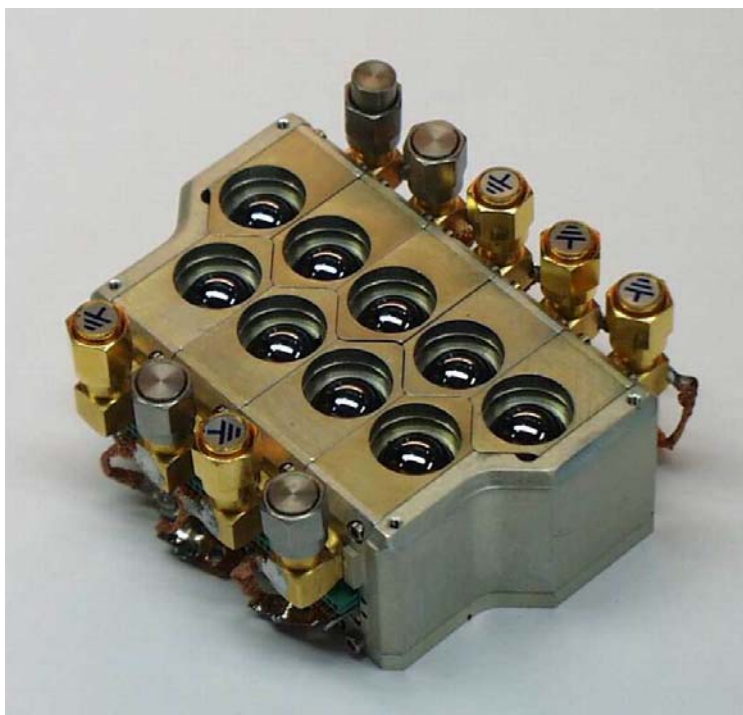
Рис. 7. Многоэлементный матричный приемник (число отдельных элементов n = 9 ) диапазона 500 ГГц с интегральным сверхпроводниковым генератором гетеродина.
