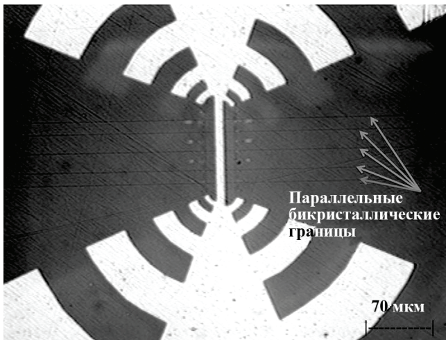
Рис. 1. Фрагмент структуры на основе пленки высокотемпературного сверхпроводника YBa_2Cu_3O_7 , включающей цепь из пяти последовательно соединенных джозефсоновских бикристаллических переходов на пяти параллельных бикристаллических границах, интегрированную с логопериодической антенной
